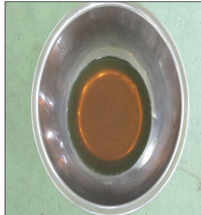
汚れたギヤオイル
